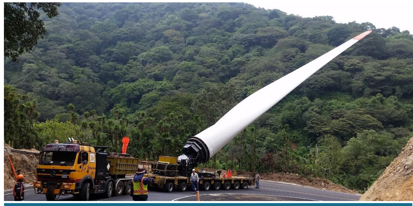
Figure 13 : Transport de pale grâce à la technologie "Blade-lifter"
